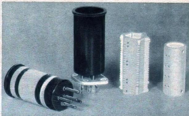
Abb. 7. Einige Kurzwellenspulkörper. Archivbild.
