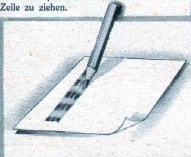
In derselben Weise, nur mit einem unsichtbaren Bleistift auf eine präparierte Glaswand gezeichnet, entsteht das ferngesehene Bild. Es ist also nicht mit einem Male da, es wird vielmehr nach und nach gebildet. — Wir müssen offenbar zum Fernsehen das „Gleichzeitig“ eines Bildes auflösen in ein „Nacheinander“, die Trägheit des Auges sorgt dann dafür, daß wir trotzdem alles nacheinander Gezeichnete auf einmal wahrnehmen — eben als vollständiges Bild.
