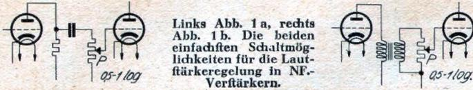
Links Abb. 1a, rechts Abb. 1b. Die beiden einfachsten Schaltungsmöglichkeiten für die Lautstärkeregelung in NF-Verstärkern.
