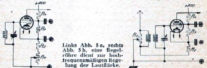
Links Abb. 5a, rechts Abb. 5b, eine Regelröhre dient zur hochfrequenzmäßigen Regelung der Lautstärke.
